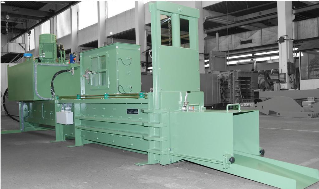
Die vollautomatische S1W-Paketierpresse eignet sich besonders zum Pressen von Blech- und Aluminiumdosen zu stark komprimierten Paketen. Diese hocheffizienten Paketierpressen zeichnen sich durch eine sehr stabile Konstruktion, hohe Leistung und lange Lebensdauer aus.
